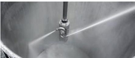
3-я передача – полная мощность насоса Например, для очистки резервуаров
